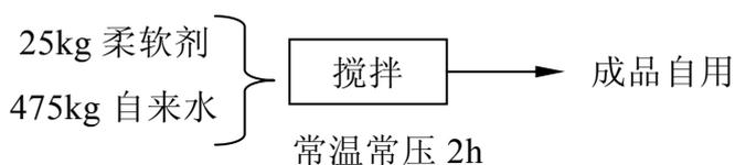
图 4-18 柔软剂复配工艺流程图
